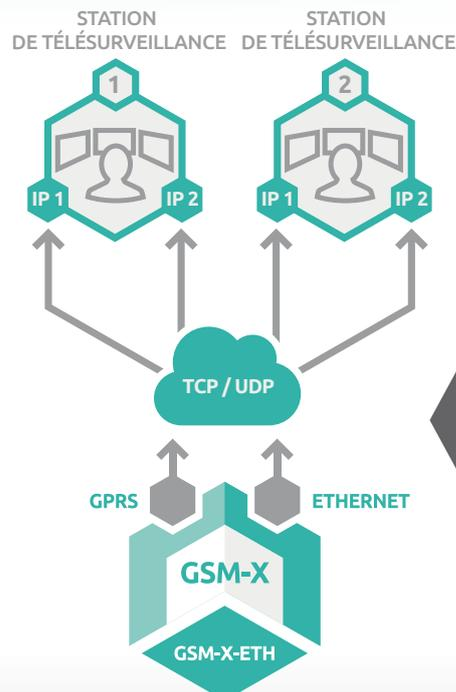
Dual Path Reporting mis en œuvre via GSM-X + GSM-X-ETH
