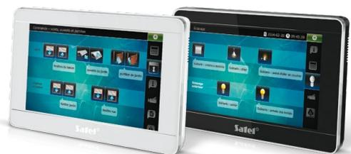
Grâce à une pleine intégration entre la centrale INTEGRA et le système de domotique KNX, il est également possible de contrôler les appareils KNX à partir des widgets INT-TSI.
