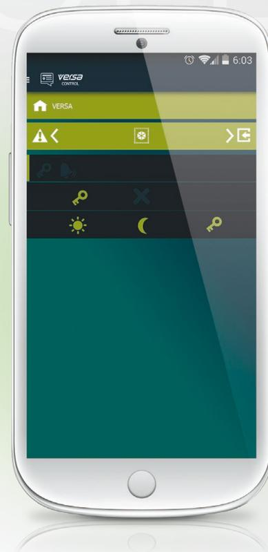
L'application VERSA CONTROL, dédiée aux appareils mobiles, permet de gérer facilement et confortablement le système d'alarme à distance, de sorte à assurer : la visualisation des événements dans le système, la visualisation des pannes en cours, la vérification de l'état du système, le blocage / déblocage d'une zone donnée, l'armement / désarmement, l'activation / désactivation et la commutation de la sortie.
